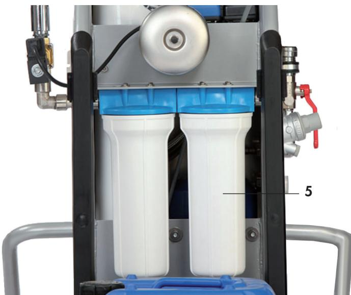
Filtertasse des Filter 5 µm (5) abschrauben.
