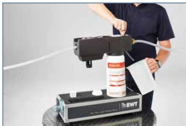
**14.** Avant de procéder au remplissage du système, il est impératif de purger et pré-rincer la cartouche. Pour cela placez un récipient en-dessous, ouvrez la vanne de purge sur l'HES, ouvrez l'alimentation en eau (robinet d'arrêt) côté entrée et pour l'AQA therm HRC-S rincer environ 5 l / HRC/SRC-L environ 15 l / SRC-XL environ 20 l d'eau.
