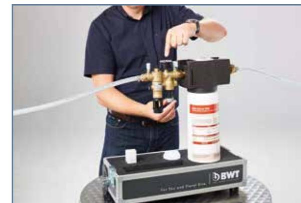
10. Le réducteur de pression est réglé sur 1,5 bar par défaut. La pression du système doit être supérieure d'au moins 2 bars à la pression de sortie réglée. Ouvrez lentement la vanne d'arrêt à bille du côté entrée et tournez la clé de réglage jusqu'à ce que le manomètre indique la pression souhaitée.
