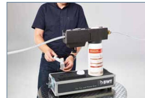
11. Déterminez la dureté de l'eau sur site avec le test de dureté total. Remplissez le récipient de dosage jusqu'à la marque 5 ml. Ajoutez le réactif goutte à goutte avec précaution (en effectuant des mouvements circulaires avec le récipient) jusqu'à ce que la couleur passe du rouge au vert. Une goutte de réactif = 1,78 °f.
