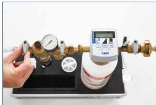
5. Vérifiez que tous les vannes à bille sont fermés et connectez le coffret de remplissage du côté entrée à la conduite d'eau potable et du côté sortie à l'installation à remplir.
