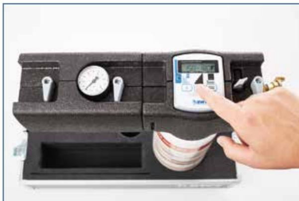
**12.** Allumez l'écran avec la touche ON/INFO et ensuite saisissez la zone de dureté de l'eau avec la touche dureté d'eau/Hardness. Les zones de dureté peuvent être sélectionnées : 0,0-10,7; 12,5-17,8; 19,6-24,9; 26,7-32; 33,8-39,2; 40,9-46,3 °f
