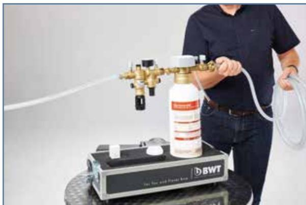
4. Montez le deuxième tuyau équipé d'un raccord rapide sur le côté sortie de la station de chauffage.
