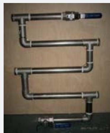
Rack de corrosion inox, avec vannes d'isolement
